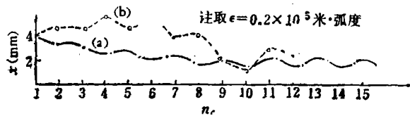
图 5 束流横向包络随单元序号 n_c 变化
