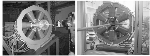
图5 六极磁铁进行谐波测量和点测量
